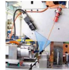
Lasertracking der Schlitzposition vor dem Schweißen. Das Aufnahmefeld der Kamera ist blau hervorgehoben, der Laserstrahl rot angedeutet
