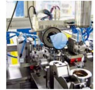
Optische Überwachung der Ringformung vor dem Kalibrieren. Das Aufnahmefeld der Kamera ist blau hervorgehoben
